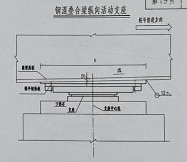
共用墩小箱梁滑板橡胶支座安装大样
