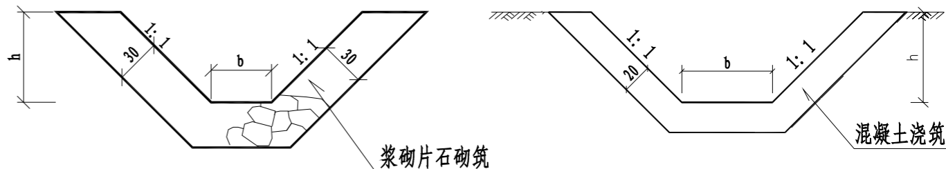
排水沟大样图 (P2型)
